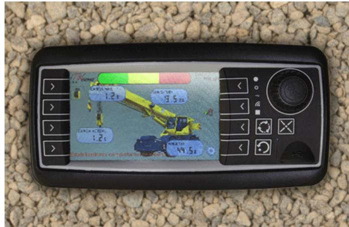
Mediante una barra gráfica, se muestra en varios colores, el momento de carga de la grúa, que varía según el peso que haya en el gancho. Una vez que se alcanza la carga máxima, el equipo emite un pitido acústico que avisa al operador y emite una señal de corte para cortar los movimientos de la grúa.
